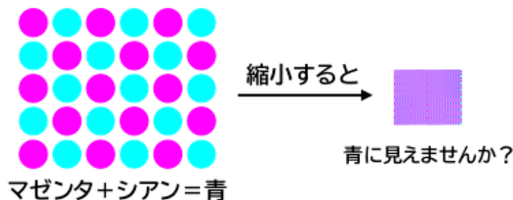
図3: インクジェット式カラー印刷における、中間色の表現
